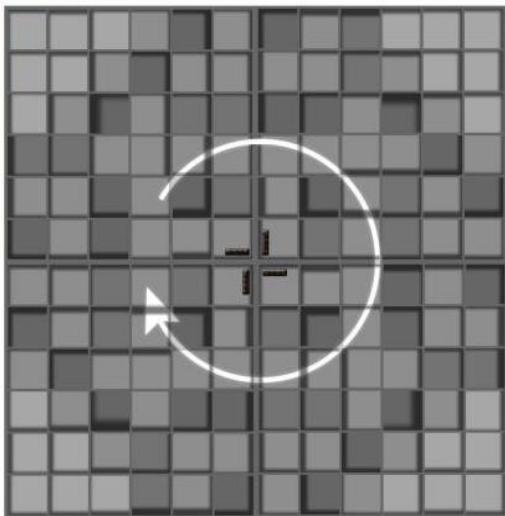
**Vier Diffusoren** lassen sich einfach zu **einem großen Diffusor** kombinieren. Dazu müssen die höchsten Kacheln jeweils zu den Ecken gedreht werden. Das erhöht die Wirksamkeit im Vergleich zu einem herkömmlichen QRD durch die Berechnungsgrundlage einer höheren Primzahl. Der HOFA Diffusor wurde mit der Primzahl 11 berechnet und durch die letzte periodische Zeile/Spalte ergänzt.
