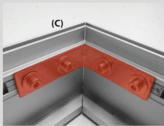
Die Rahmenprofile mit 4 Eckwinkeln (C) in der seitlichen inneren Nut verbinden.
