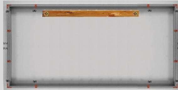
Holzplatte zwischen die Rahmenprofile an die Wand schrauben und die Absorberplatten mit Akustik-Kleber auf die Holzplatte kleben.
