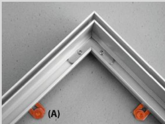
Den Rahmen an den Aufhängern (A) mit Dübeln direkt auf der Wand verschrauben. Bitte darauf achten, dass die gegenüberliegenden Rahmenteile parallel montiert werden.
