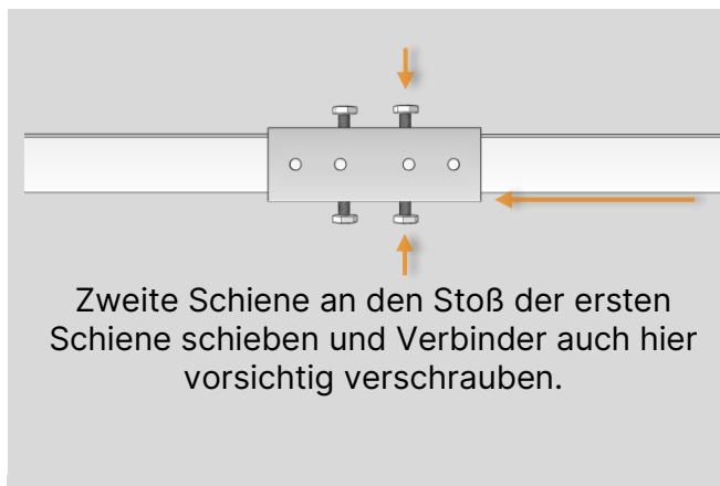
Zweite Schiene an den Stoß der ersten Schiene schieben und Verbinder auch hier vorsichtig verschrauben.
