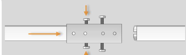
Eine Schiene bis zur Hälfte in den Verbinder schieben und mit beiden Feststellschrauben gleichmäßig fixieren. **Nicht zu stark anziehen, sonst wird die Schiene zusammengedrückt und die Rollen klemmen.**
