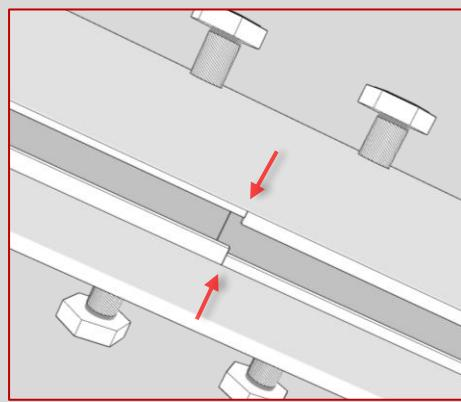
Die entsprechenden seitlichen Schrauben leicht lösen.
