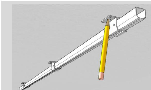
Gesamtes Montageset oder das Teilstück des Sets bis zum ersten Verbinder anhalten und Bohrlöcher an der Decke anzeichnen.
