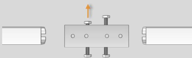
Die seitlich angebrachten Fixierungsschrauben des Verbinder so weit zurückdrehen, bis man den Verbinder auf die Schiene schieben kann.
