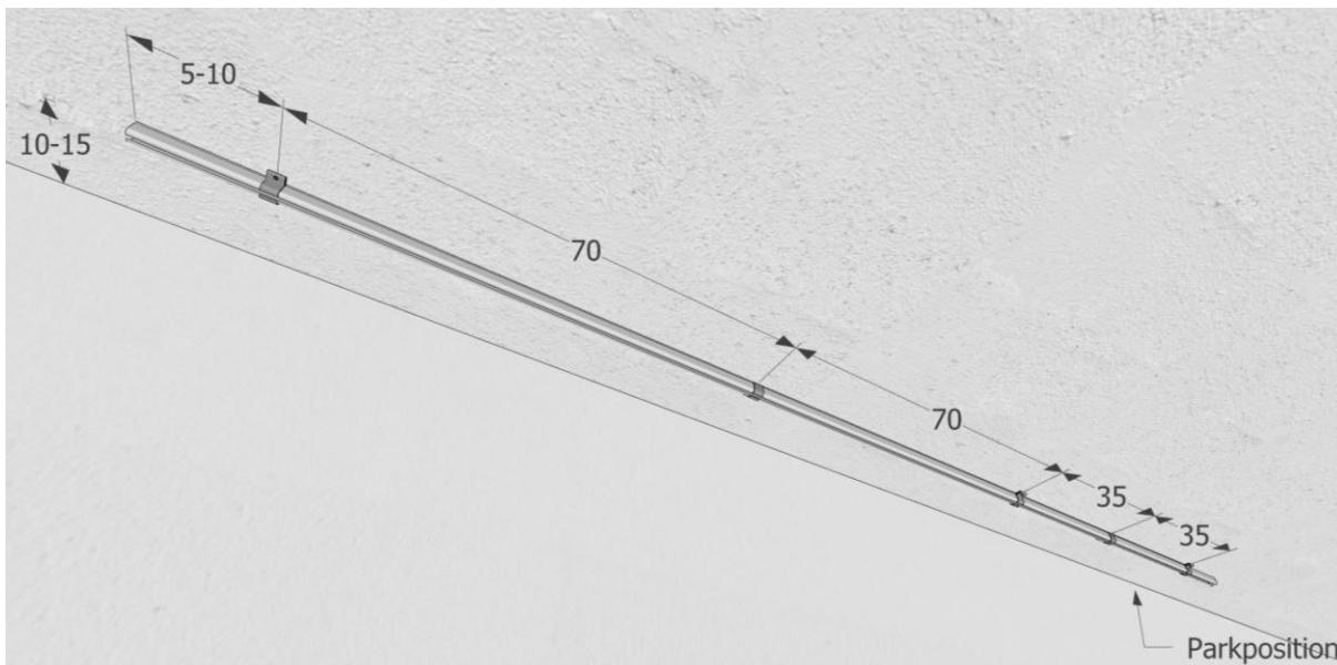
Bei geteilten Schienensystemen sollte zur Stabilisation je ein Halter vor und nach dem Verbinder angebracht werden:
