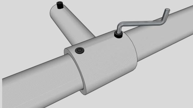
Die 4 Madenschrauben zur Klemmung der Stange mit einem 4 mm Inbusschlüssel gleichmäßig anziehen, bis die Stange fest geklemmt wird.
