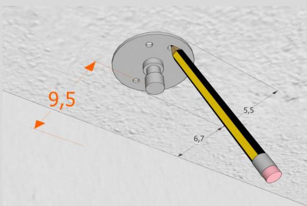
Die Bohrlöcher mithilfe der Grundplatte des Wandhalters anzeichnen.
