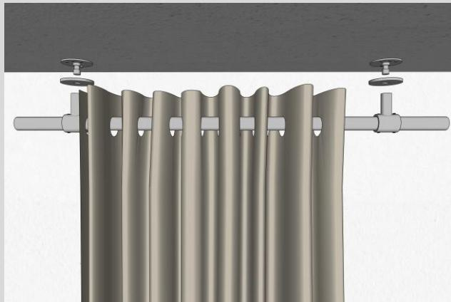
Vorhangsstange mit den Blenden unter den Grundplatten positionieren und in die Halter in die Grundplatten einschieben.
