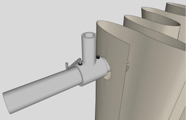
Zweite Deckenhalterung auf die Stange aufschieben und mit den Madenschrauben befestigen.
