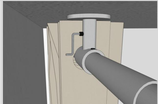
Position halten und beide Madenschrauben am Halter schließen.
